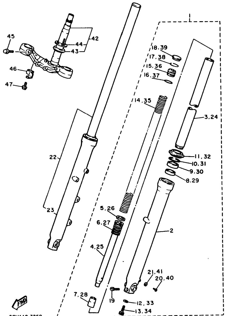
FIG. 25 HORQUILLA DELANTERA
