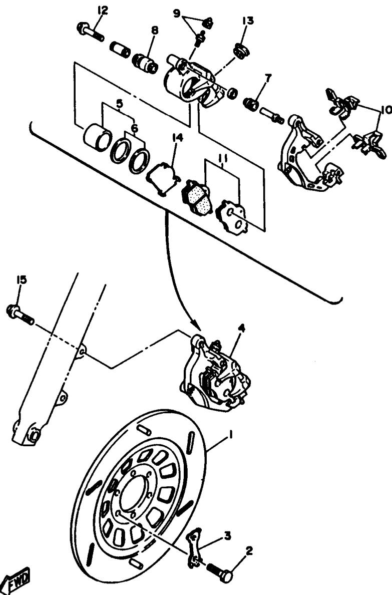
FIG. 29 CALIBRE FRENO DELANTERA
